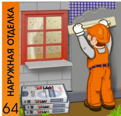
Просохшую после пропитки поверхность оштукатурить **тонкослойной гидрофобной цементной штукатуркой Krasland ГАЗОБЕТОН-3 с использованием штукатурной сетки (толщина слоя 0,5 - 1 см.)**
