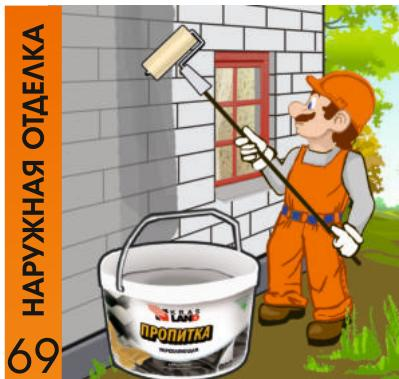
Обработать поверхность укрепляющей пропиткой для внутренних и наружных работ Krasland G02 с увеличенным содержанием дисперсии, и дать просохнуть
