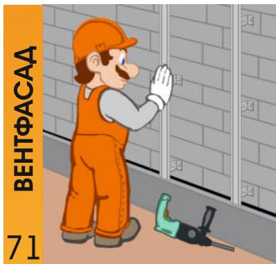
Крепление кронштейнов системы навесного вентилируемого фасада производить с помощью **анкеров**. После крепления кронштейнов произвести монтаж профиля
