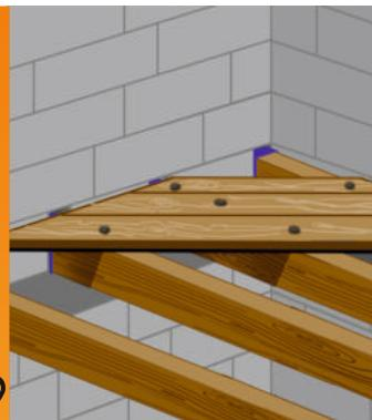
Балки перекрытий (покрытий) следует конструктивно связывать с антисейсмическим поясом и устраивать по ним сплошной дощатый диагональный настил
