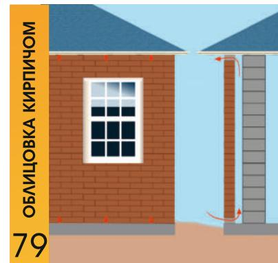
**Гибкие связи** обеспечивают создание вентиляционного зазора в 30-50 мм между несущей стеной из газобетона и облицовкой из кирпича. В кирпичной кладке необходимо устраивать продухи понизу и поверху, для циркуляции воздуха, 75 см<sup>2</sup> на 20 м<sup>2</sup> кладки
