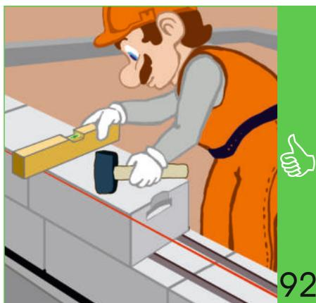
Киянка резиновая с деревянной ручкой применяется для точного позиционирования вновь уложенных блоков в кладке. Резиновая головка позволяет при работе избежать деформации газобетонных блоков.
